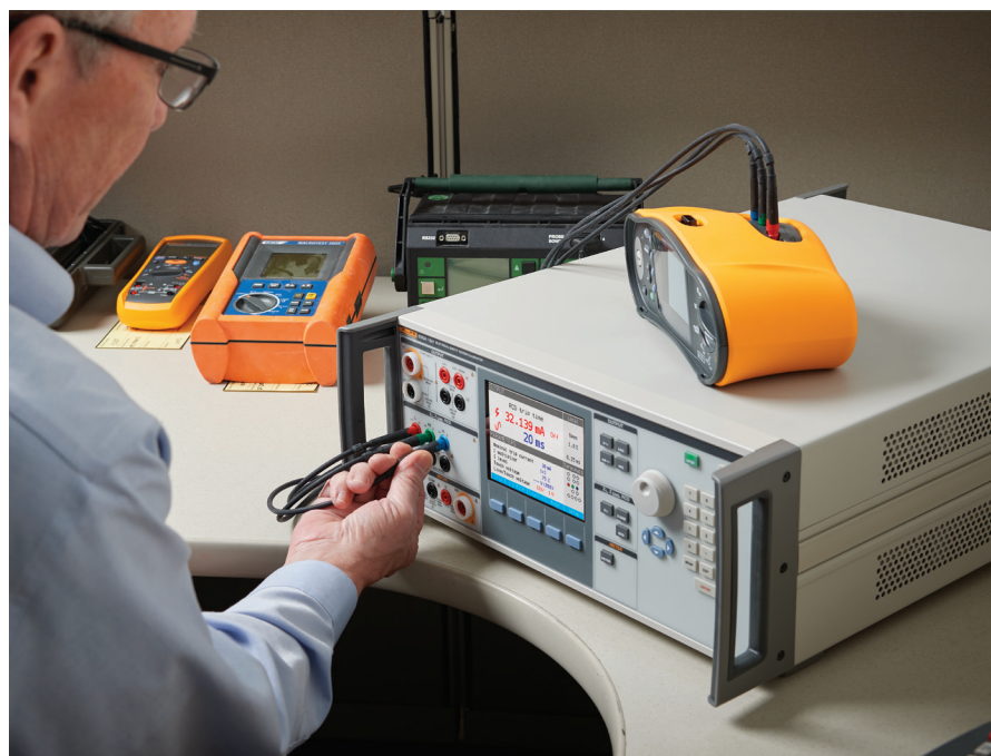
Chaque 5322A est accompagné d'un multiplicateur de résistance externe, pour alimenter les résistances jusqu'à 10 TΩ, afin de tester les contrôleurs d'isolement.
